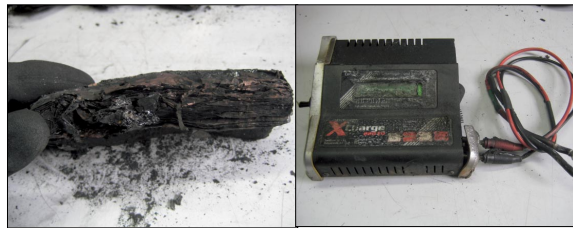
Abb.5, 6: Überreste des Modellbauakkus; Ladegerät
