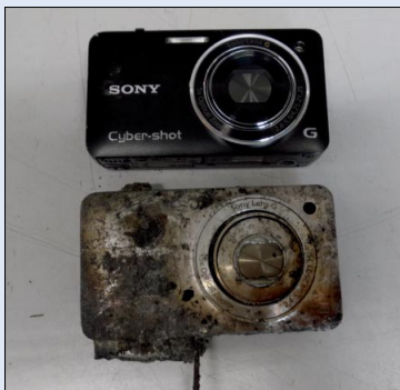
Abb.8: Bei dieser Kamera hat der Akku gebrannt
